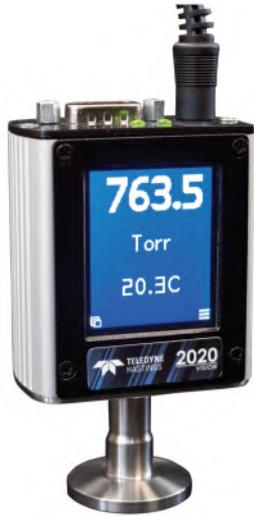
컴팩트하고 사용하기 편한 HVG-2020A 진공 측정 센서는 1,000 Torr(133,322.3 Pa)에서 1 Torr(133.3 Pa) 미만의 범위에서 매우 안정적이고 정확한 측정을 제공합니다. HVG-2020A는 매우 간편하게 설치할 수 있습니다. Touch Display는 다양한 Views와 작동 옵션을 제공합니다. 가스 접촉부는 스테인레스 스틸 제질로 되어 있고 다양한 현장 상황에 적합한 Analog / Digital output 를 제공하고 있으며, Linear 한 Analog output 을 제공하고 있기 때문에 고가의 Capacitance Manometers 보다 경제적입니다. HVG-2020A 는 고급 압력 저항센서를 기반으로 진동막에 가스에 의해 좌우되는 힘을 감지해 압력과 압전 재료 변화의 저항값을 측정하기 때문에 가스 성분이 바뀌어도 보정 작업 없이 측정이 가능합니다.
