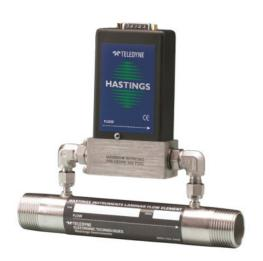
HFM 200 LFE 는 주변 환경에도 매우 안정적인 결과를 보여주는 기체용 질량 유량계 및 제어기 입니다. 0~25 slm 에서 15,000 slm(N2) 까지의 측정범위를 가지고 있습니다. Lamiar Flow 배관은 3/8" 부터 8" 까지 선택 가능합니다. ±(1% of full scale) 정확도
